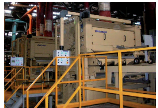
6-головочная система Nova-H в одной из линий производства фанеры в России
